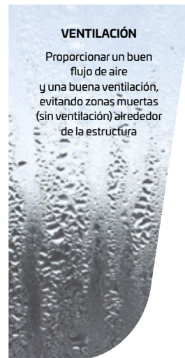
SUPERFICIE Superficie seca y la temperatura de la superficie debe estar siempre 3°C por encima del punto de rocío
