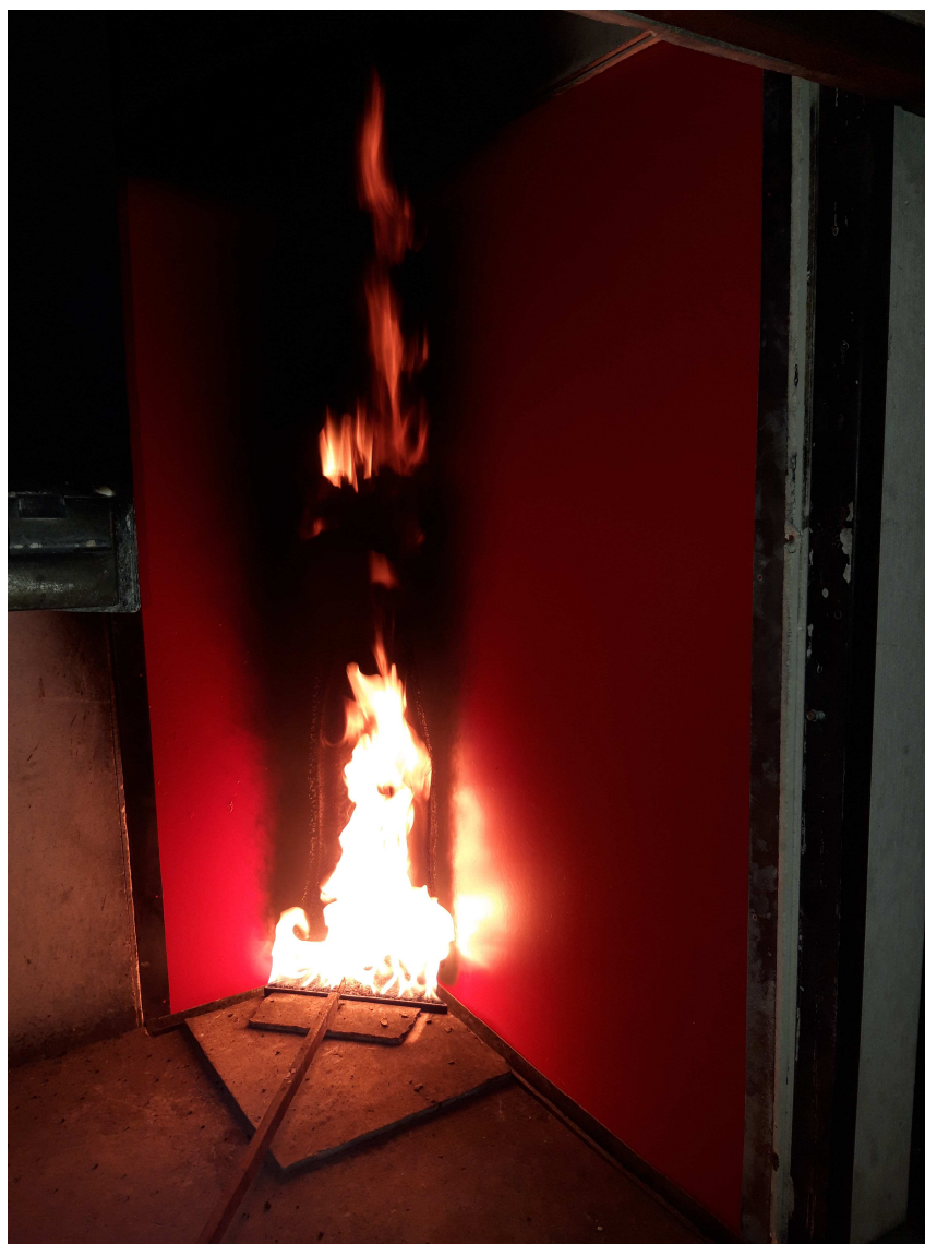
Aspecto de la muestra durante el ensayo de SBI según EN 13823
