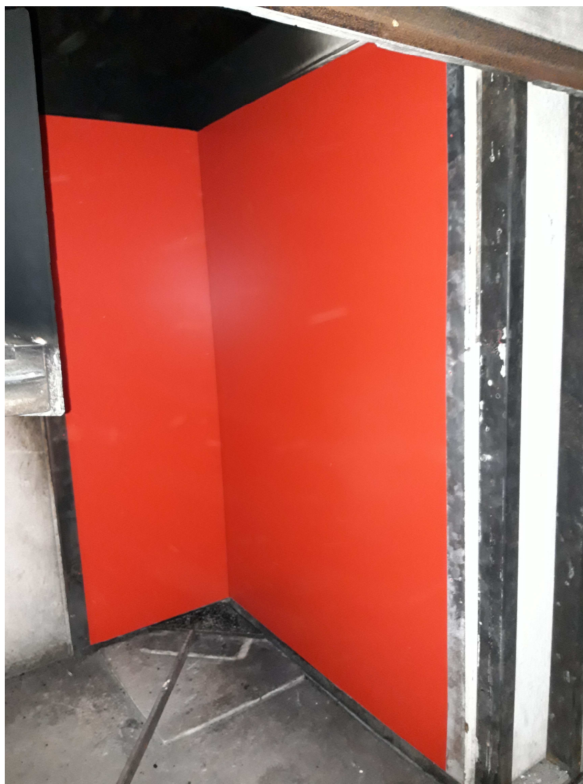
Aspecto de la muestra antes del ensayo de SBI (ala corta y ala larga) según EN 13823
